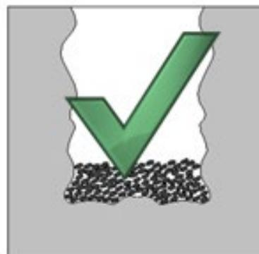
avec drainage / tube de drainage (p.ex. sous-sol mou)
